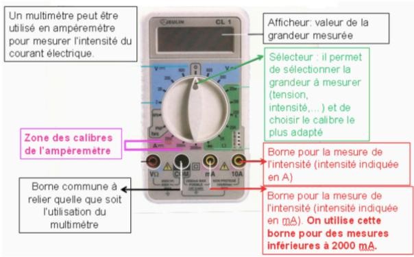
L'appareil de mesure de l'intensité du courant se nomme <u>ampèremètre</u>. On mesure l'intensité du courant qui traverse un appareil électrique en plaçant l'ampèremètre <u>juste avant ou juste après cet appareil</u>. On dit que <u>l'ampèremètre se branche en série</u>. Pour mesurer l'intensité du courant qui traverse une lampe, on positionne l'ampèremètre juste avant ou juste après cette lampe.
