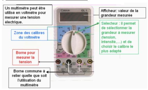
L'appareil de mesure d'une tension électrique se nomme <u>voltmètre</u>. On mesure la tension électrique aux bornes d'un appareil électrique en plaçant le voltmètre <u>autour de cet appareil</u>. On dit que <u>le voltmètre se branche en dérivation</u>. Pour mesurer la tension électrique aux bornes d'une lampe, on positionne le voltmètre autour de cette lampe en utilisant 2 fils électriques.
