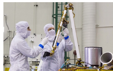
Image 3 - Test d'un bras robotique IDA effectué par des chercheurs (NASA)
