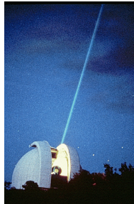
Image 2 - Tir laser vers la Lune depuis l'observatoire de la Côte d'Azur
