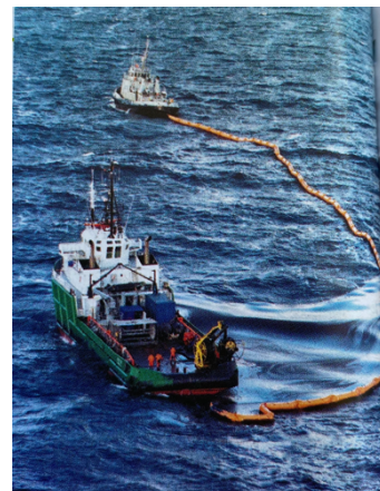
Image 1: Barrage flottant permettant de contenir une nappe de pétrole.
